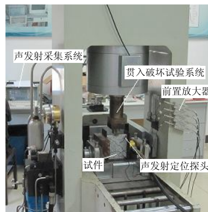
图 6 贯入破坏试验系统
