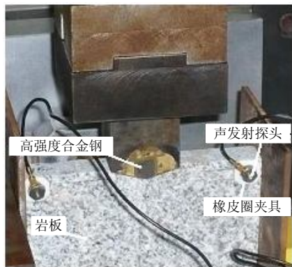
图 9 声发射传感器布置
